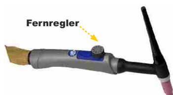
Brenner Typ 5XT-26 (gasgek. für WIG 250) bzw. 5XT-18 (wassergekühlt, für WIG 250W-350W) mit integriertem Fernregler direkt am Brennergriff. Mit Lederapplikation. 4m oder 8m.
