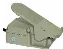
Optional: Fußregler SW: sehr stabile und robuste Ausführung aus Aludruckguß für den rauen Einsatz. Start/Stopfunktion über Fußregler. 5 Meter Kabel mit Stecker. Leistungsbereich über Fußregler begrenzbar.
